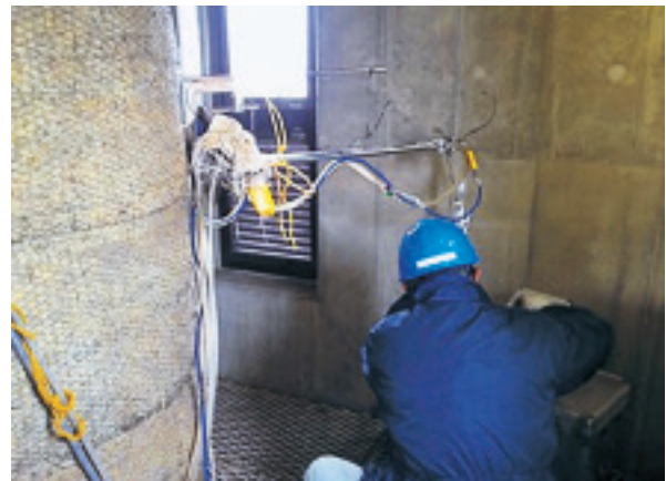
写真1-3-4 排出ガス中のダイオキシン類濃度の測定
