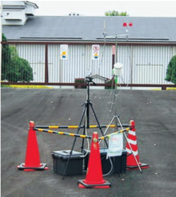
写真1-3-3 環境大気中の石綿濃度の測定
