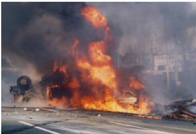
移動タンク貯蔵所横転による火災の事故例
