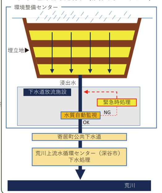
当センターでは、サンドイッチ工法による埋め立てを行っています。廃棄物を2.5mの高さに埋め立て、その上に0.5mの中間覆土を行い、これを繰り返しています。また、毎日搬入が終了した段階で、廃棄物が露出しないよう即日覆土0.3mを行っています。このような工法により、廃棄物の飛散、悪臭、害虫、火災の発生を防止しています。
