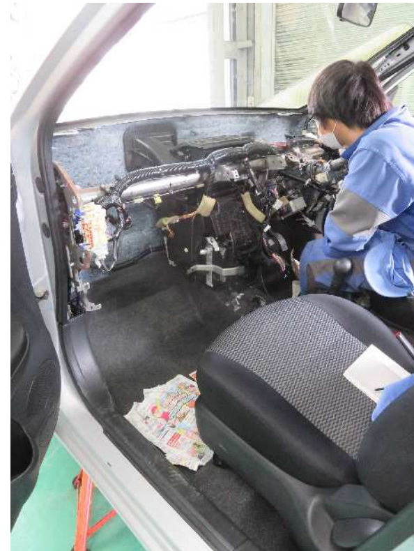
【エアコン整備】
