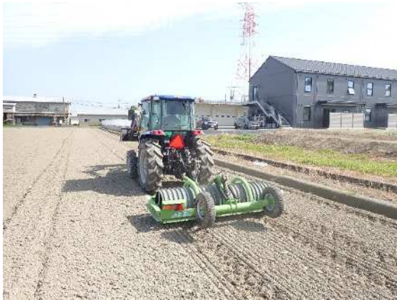
図3-7 K型ローラによる鎮圧作業
