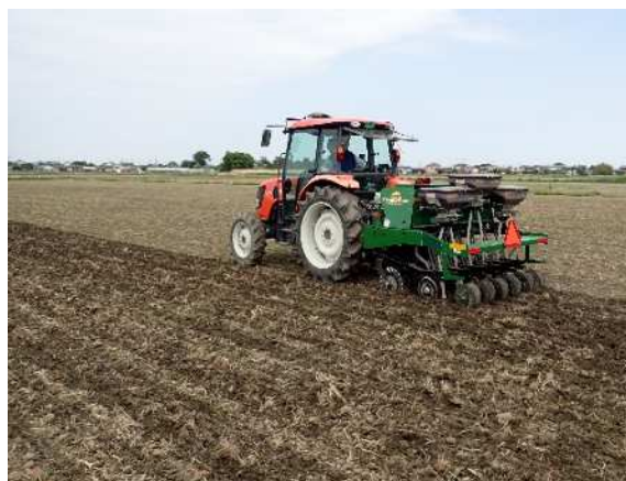
図4-6 海外製グレーンドリルによる播種作業
