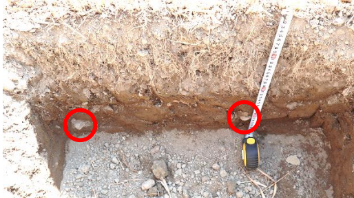
土壌断面、赤丸で囲んだところが石礫 (玉井試験場内,2019)
