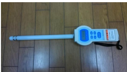
写真 左：膈内電気抵抗値の測定機器「ブリードテスタ P I T - 1」（チヨダエレクトリック株式会社） 右：測定の様子
