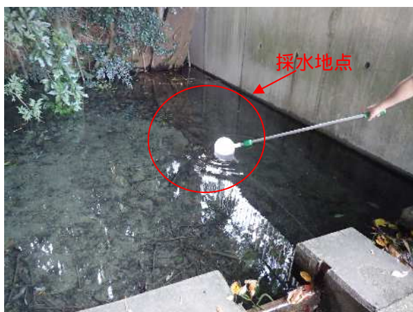
1段目の溜桝の中央付近で採水を行った
