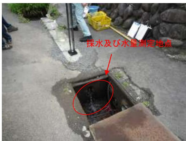
コンクリート鉄蓋を外したところで、採水及び水量の測定を行った
