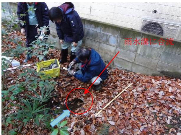
雨水管に合流する地点で水量を測定
