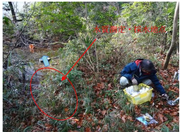
湧水は、池の上流の地面からじわじわと湧出していると推定されたため、池の上流部で水質測定・採水を実施
