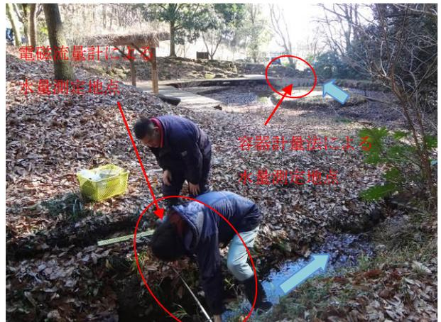
水路として整備されている湿地帯下流部で水量を測定
