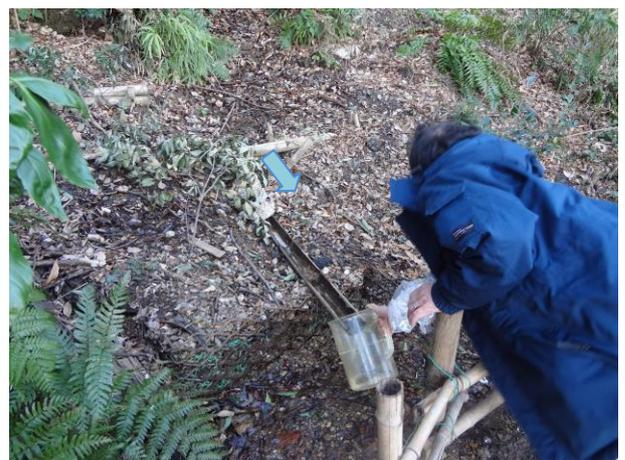
湧水地点の下流には樋が設置（水質・水量の測定、採水を実施）
