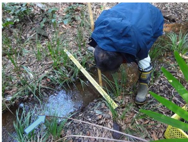
複数の湧水が合流する下流側で水量を測定
