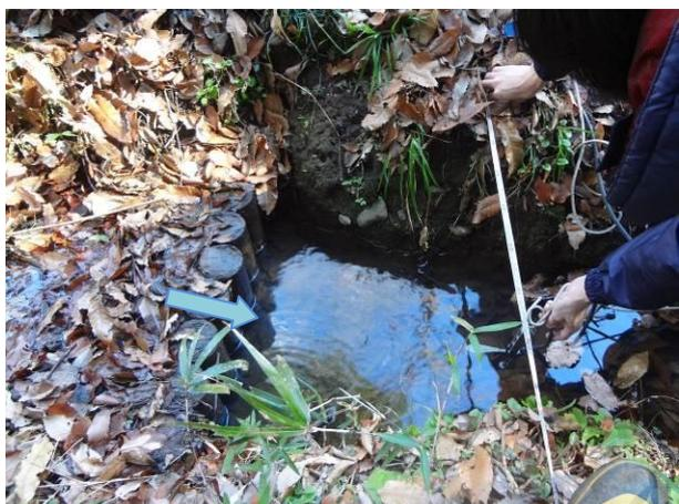
電磁流量計による水量測定
