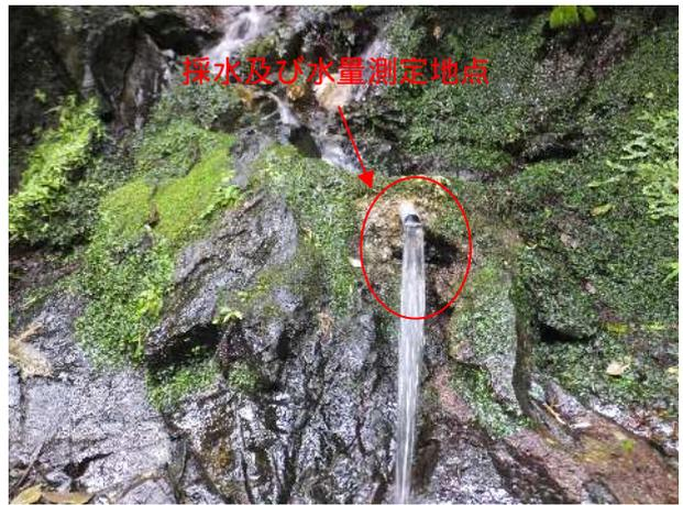
塩ビパイプから流れ出たところで、採水及び水量の測定
