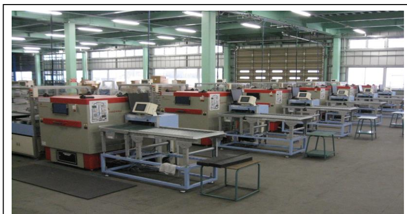
写真－1 あんぼ柿用非破壊検査器
