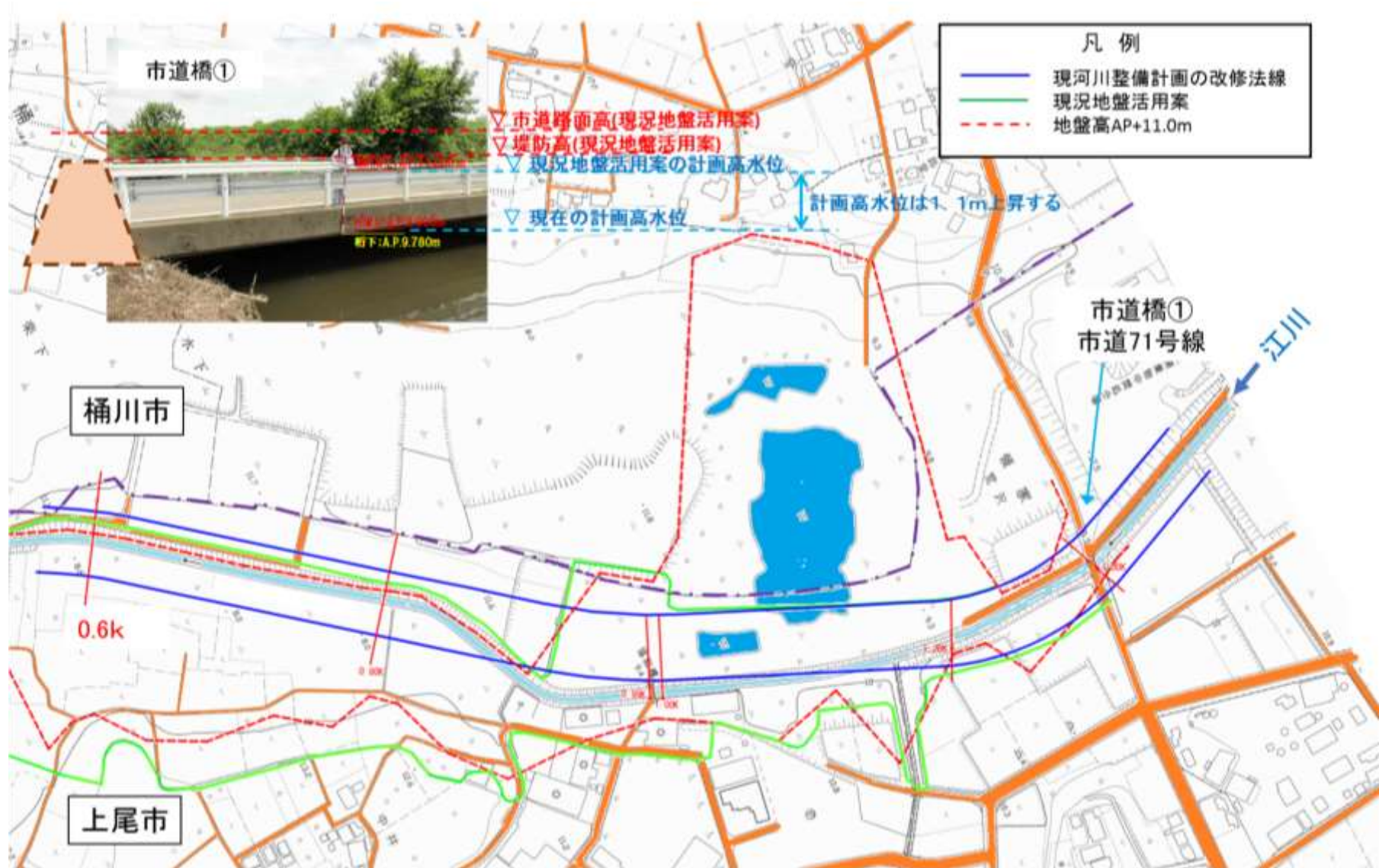
図-4 市道71号線橋梁の水位上昇予測状況
