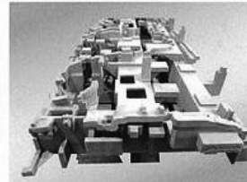
アルミ検具鋳物素材 (1.8m×3.8m 1200kg)
