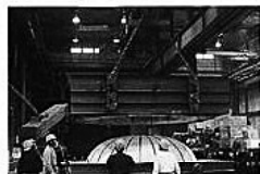
自社開発の大型鋳型反転機による 大型アルミ鋳物の鋳造
