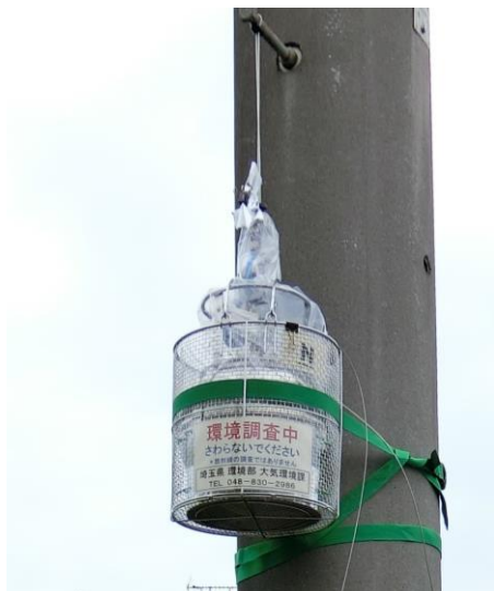
<試料採取容器設置例（電柱）>
