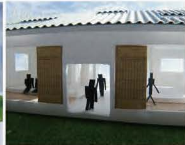
中央に通る土間は合意の間、トンネルのような役割を果たす。換気が良くなり暑い空気がこもらない。冬は、屋根に設けたトップライトによって温かい空間ともなる。
