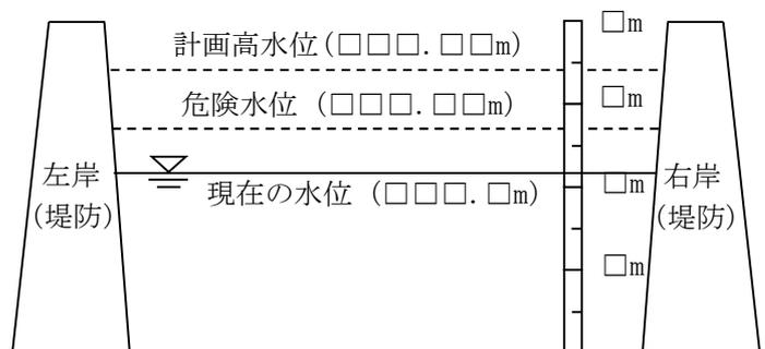
※計画高水位は、河川を整備する上での基本となる水位で、計画の洪水を流すことができる最高の水位です。
