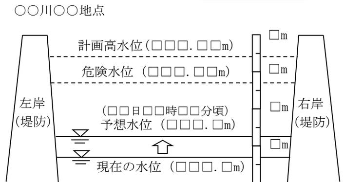
※計画高水位は、河川を整備する上での基本となる水位で、計画の洪水を流すことができる最高の水位です。
