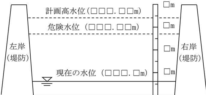
※計画高水位は、河川を整備する上での基本となる水位で、計画の洪水を流すことができる最高の水位です。
