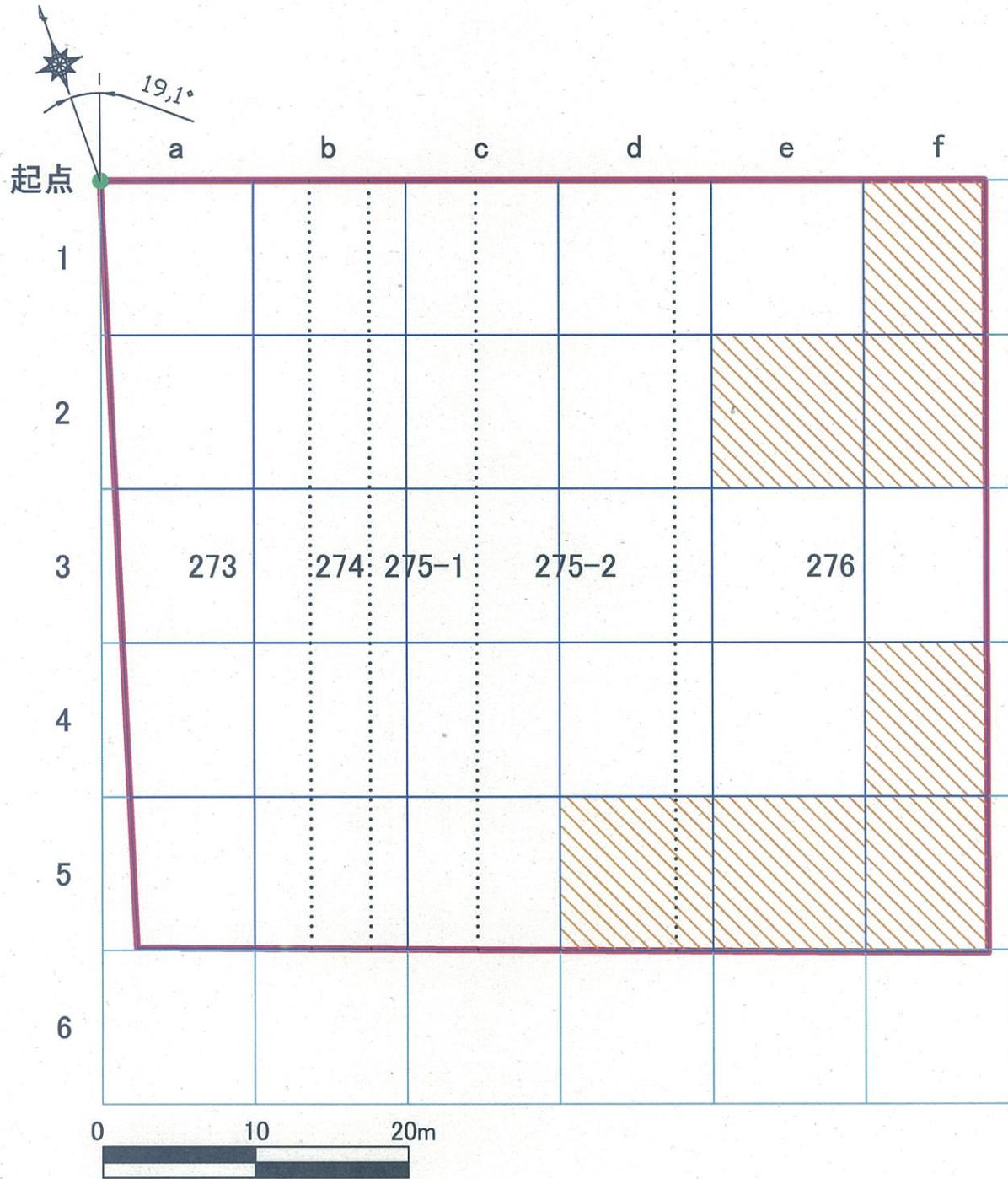
※調査範囲の最北端(三郷市栄4丁目273の最北端)を起点とし、起点から東西及び南北方向に10m間隔で引いた線により格子状に調査範囲を区画(単位区画)します。なお、単位区画の数を最小にするために起点を支点として右回りに格子の線を19.1度回転します。
