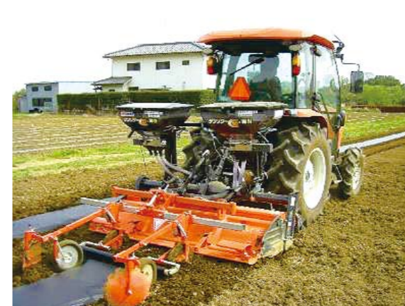
直進アシスト付きトラクタによるマルチ張り作業(左)と 作業後の圃場の様子(右) (滑川町)
