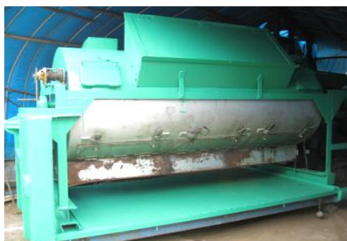
図 2 製造用加熱攪拌機
