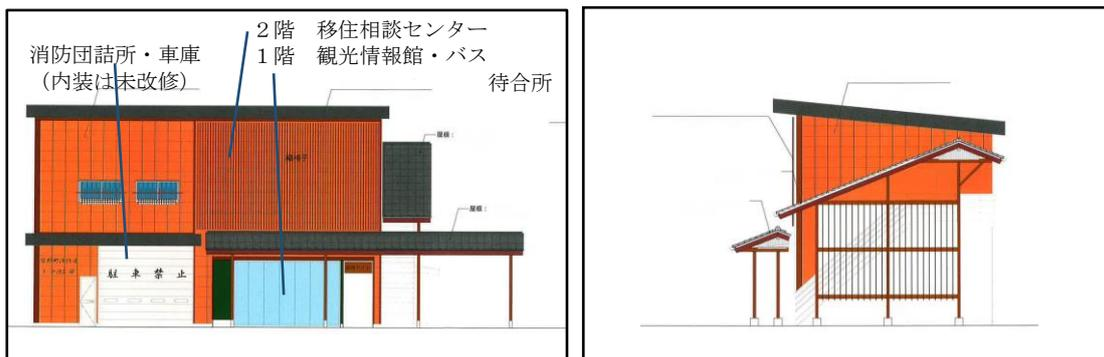
改修後の建物立面図 (内装改修面積 109 m<sup>2</sup>)
