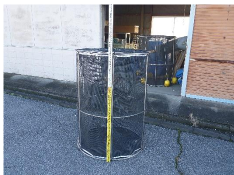
写真 1 試験で使用した網生け簀 (直径 1m×高さ 1.5m)
