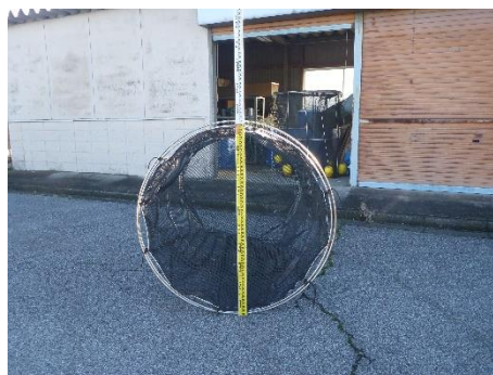
写真 1 試験で使用した網生け簀 (直径 1m×高さ 1.5m)
