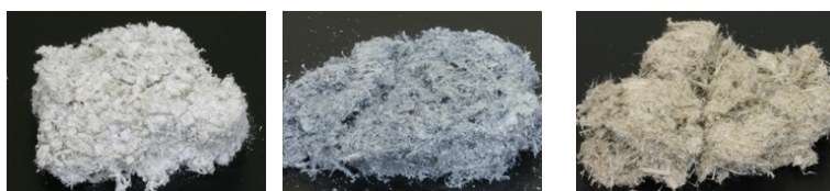
写真 石綿(左からクリソタイル、クロシドライト、アモサイト)
