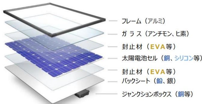
シリコン系太陽電池モジュールの構造（有害・資源性物質）
