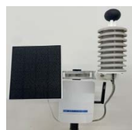
図1 （株）渡辺製作所が製作したIoT暑さ指数計
