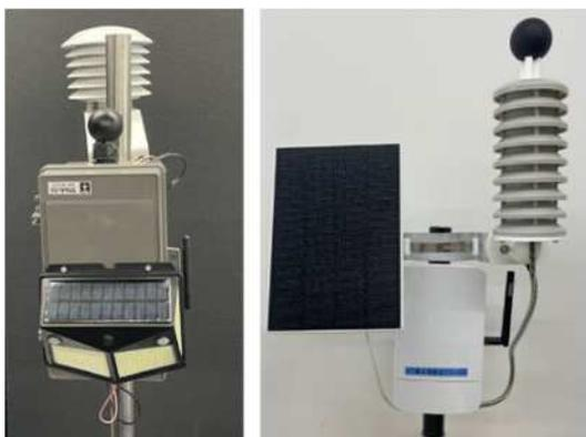
図2 IoT暑さ指数計(左：昨年度までの機器、右：今年度開発した機器)
