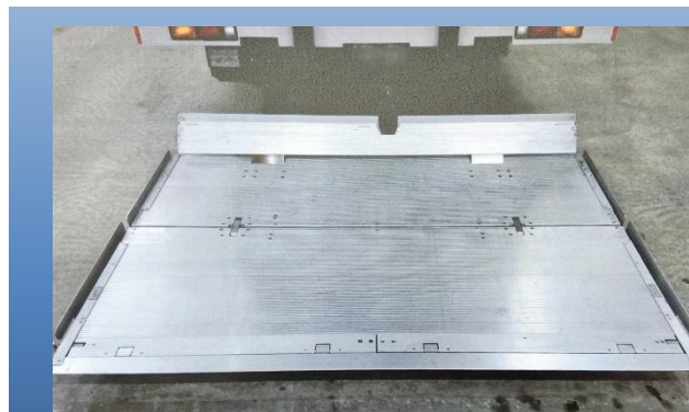
トラックの後部に装着された 「テールゲート昇降装置」
