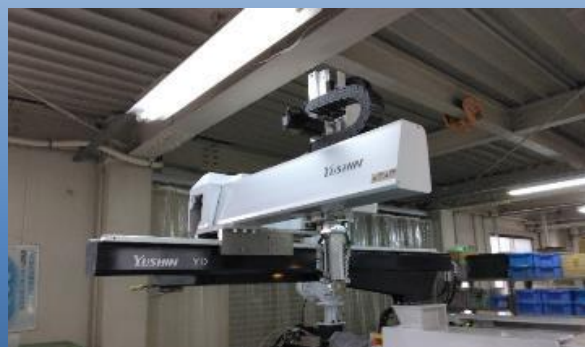
金型からの製品取出し作業をおこなう「取出口ロボット」
