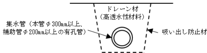
図1-7-51 暗渠排水工の基本構造
