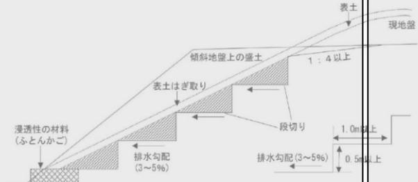
図1-7-9 基礎地盤の段切り例
