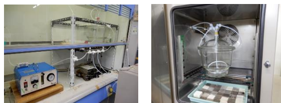
図2 オゾンガス曝露試験
