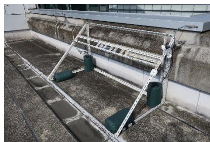
図1 耐候性試験の状況
