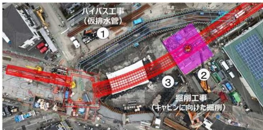
②地上からキャビンに向けて縦に掘削（地盤改良施工状況）
