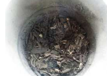
敦賀セメントで 焙焼無害化された電池
