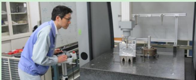
※三次元測定機による精密測定の様子
