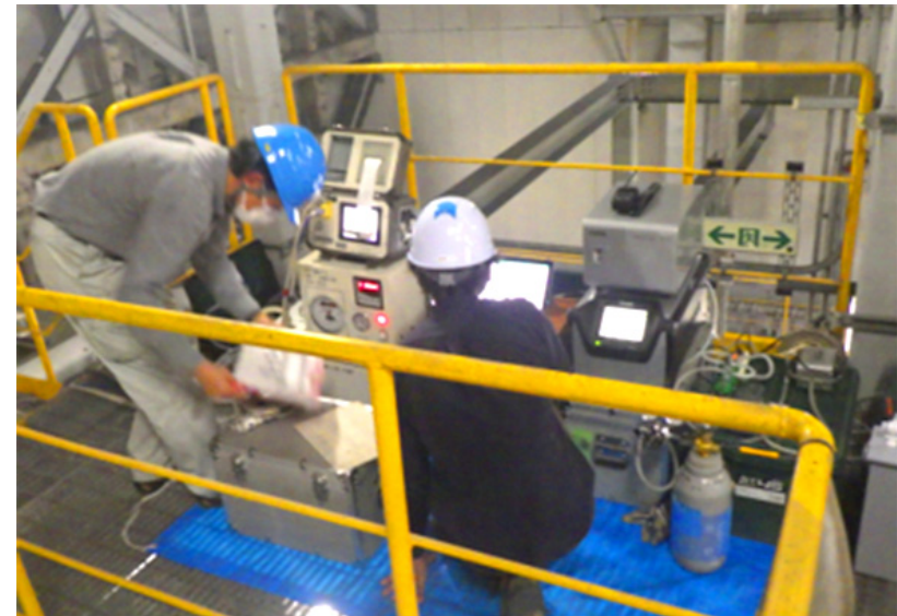
写真6-3 排出ガス中のダイオキシン類濃度の測定
