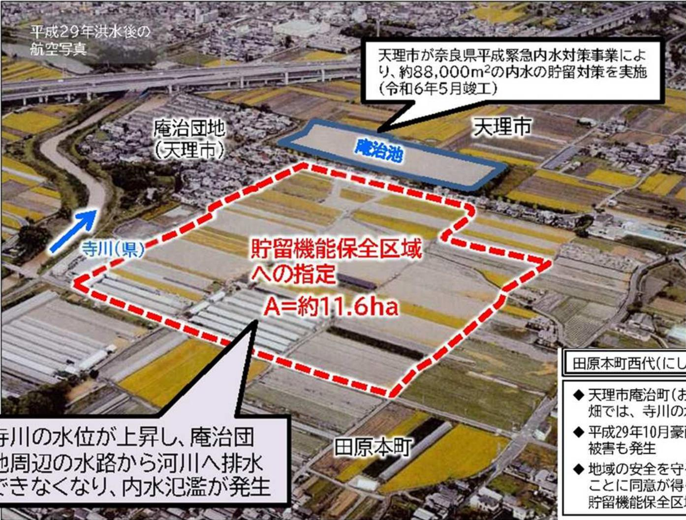
天理市が奈良県平成緊急内水対策事業により、約88,000m<sup>2</sup>の内水の貯留対策を実施 (令和6年5月竣工)
