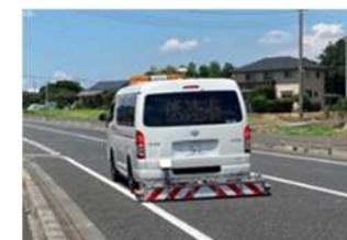
路面下空洞調査の状況
