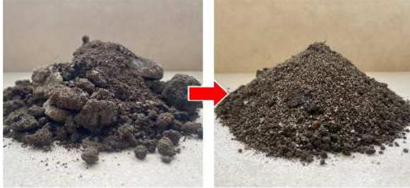
2 改良材を使用しない埋戻し用砂質土
