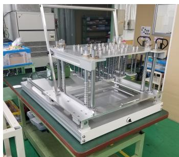
開発した、多面付け高精度はがき仮貼り装置
