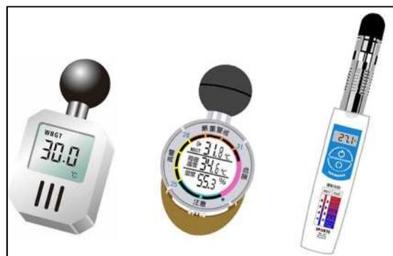
図2-9 携帯型（ハンディータイプ）の電子式暑さ指数（WBGT）計
