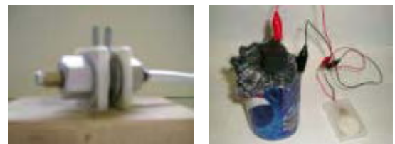
実験した「燃料電池」と「炭素電池」
