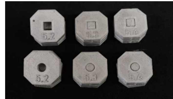
5.2mm穴 (クリアランス 0.1mm) 5.3mm穴 (クリアランス 0.15mm) 5.4mm穴 (クリアランス 0.2mm)
