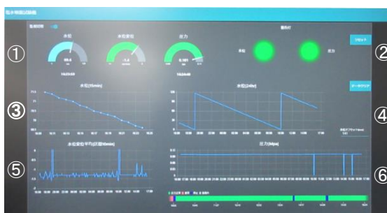
図 6 水位と噴霧圧力の監視画面
