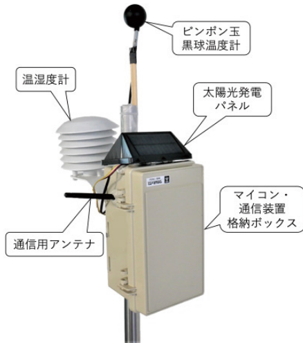
図2 当センターで開発したIoT暑さ指数計
