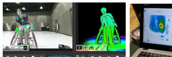
図3 座位姿勢計測システム（左）および重心計測システム（右）の、動作確認実験の一例
