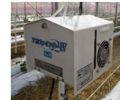
統合環境制御装置
