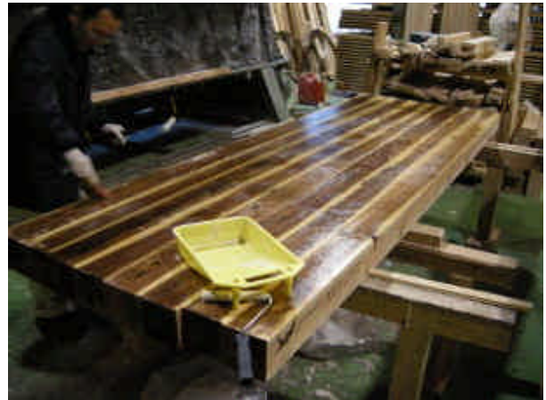
写真1 接着材の塗布
