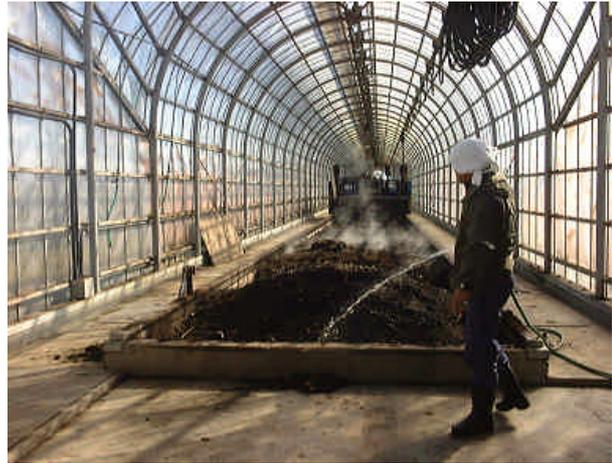
図2 堆肥化材料に処理水を混合
