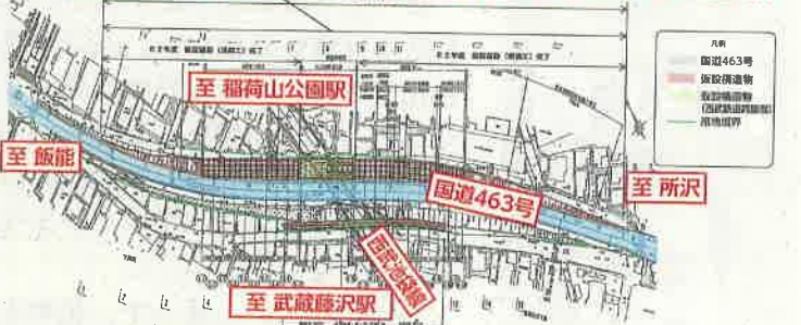
令和3年度 仮設道路 (跨線部: 鉄道施工、仮設道路の安全施設工・舗装工 (県施工) - 仮設道路完成、通行止め解除)
