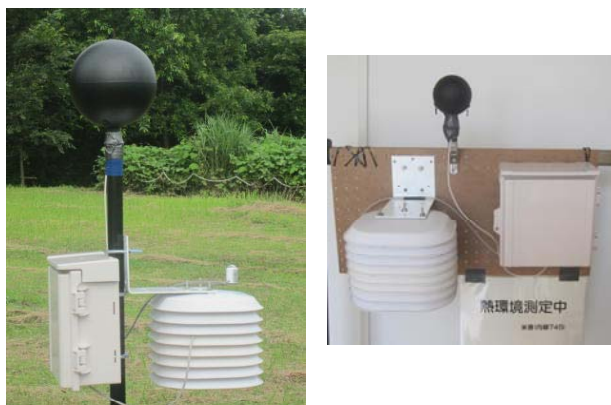
写真1 WBGT計測装置(左: 野外用、右: 室内用)
